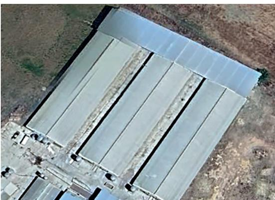
Imagen 3. Sombras eólicas entre las 3 naves que impiden su correcta ventilación laterales: la nave central es la más afectada.
